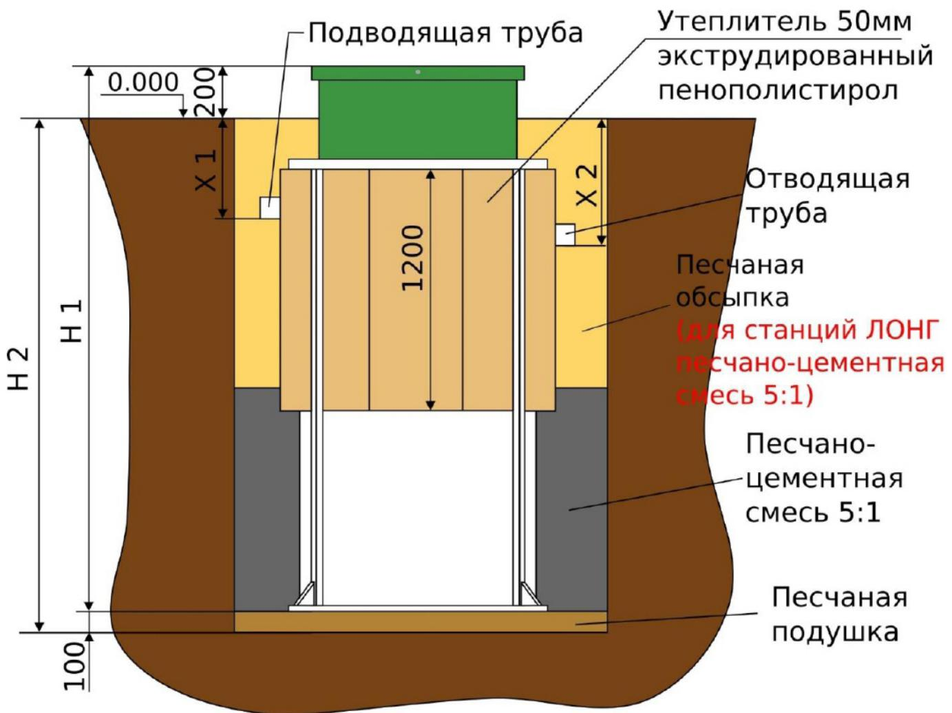
Рисунок 1. – Размеры станции «ЕВРОБИОН - АРТ»
