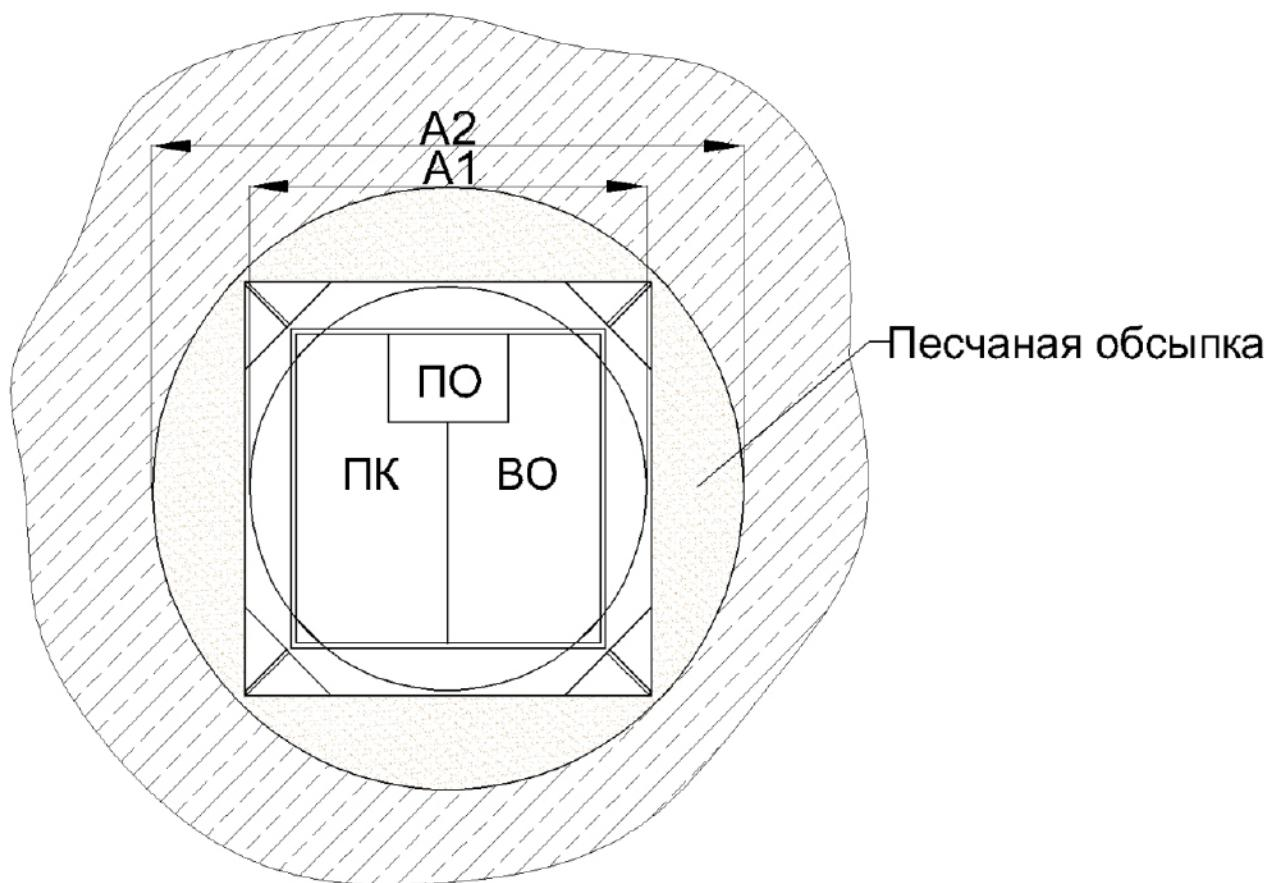
**Рис. 2. Обозначение габаритных размеров станции «ЕВРОБИОН - АРТ»
