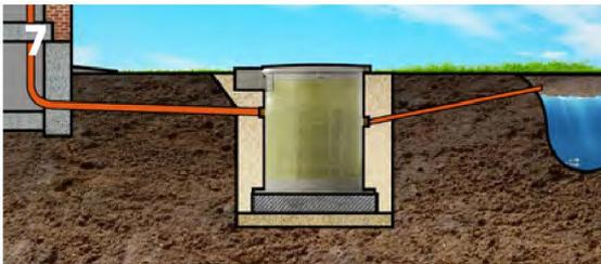
Прокладка отводящего и подводящего трубопроводов. Утепление труб. Подводящий трубопровод должен быть с уклоном 3 см на 1 м.
