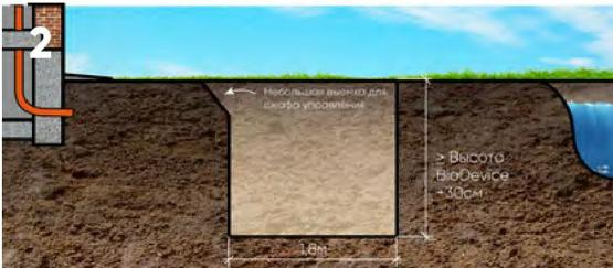
Выемка грунта. Размер котлована: диаметр - 1,8 м, глубина - высота БиоДевайса + 0,3 м под железобетонную плиту и песчаную подушку.
