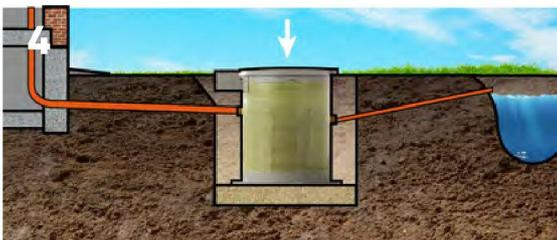
Установка станции по уровню. Прокладка отводящего и подводящего трубопроводов. Утепление труб. Подводящий трубопровод должен быть с уклоном 3 см. на 1 м.
