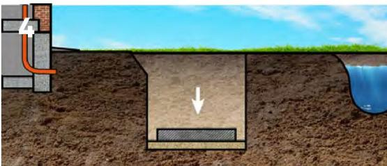
Установка по уровню железобетонной плиты-основания. Диаметр плиты - 1,5 м., толщина 20 см.
