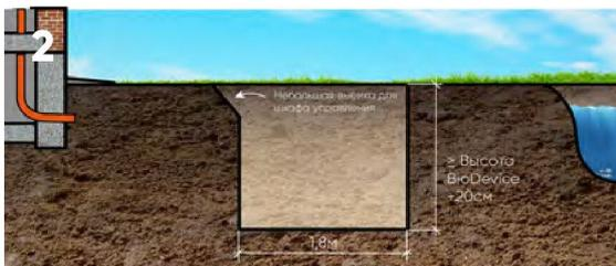
Выемка грунта. Размер котлована: диаметр - 1,8 м, глубина - высота БиоДевайса + 0,2 м под песчаную подушку.
